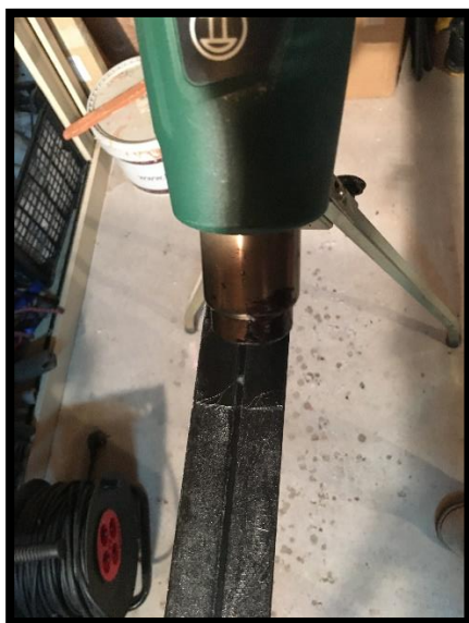
Chauffage au décapeur thermique
